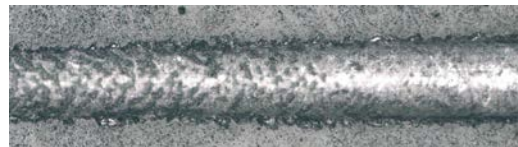
Fig 8. Ensayo de microrayado Lc2: 15,8 N
